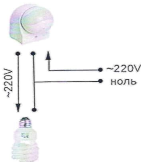
Рисунок 1. Схема подключения датчика движения
